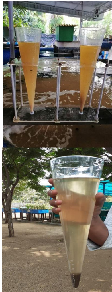
شکل ۳: نمونه ای از قیف‌های مدرج ایمهوف جهت اندازه‌گیری
